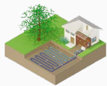
Pompe à chaleur sur capteurs enterrés horizontaux
